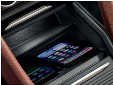
Функция беспроводной зарядки телефонов для двух телефонов мощностью 15 Вт с функцией охлаждения (Wireless Charging).
