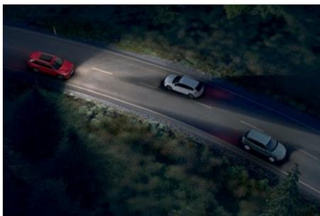
Передние светодиодные фары с матричной функцией, в которых распределение, дальность и направление пучка света регулируются автоматически, чтобы обеспечить оптимальную видимость и не ослеплять других участников дорожного движения.
