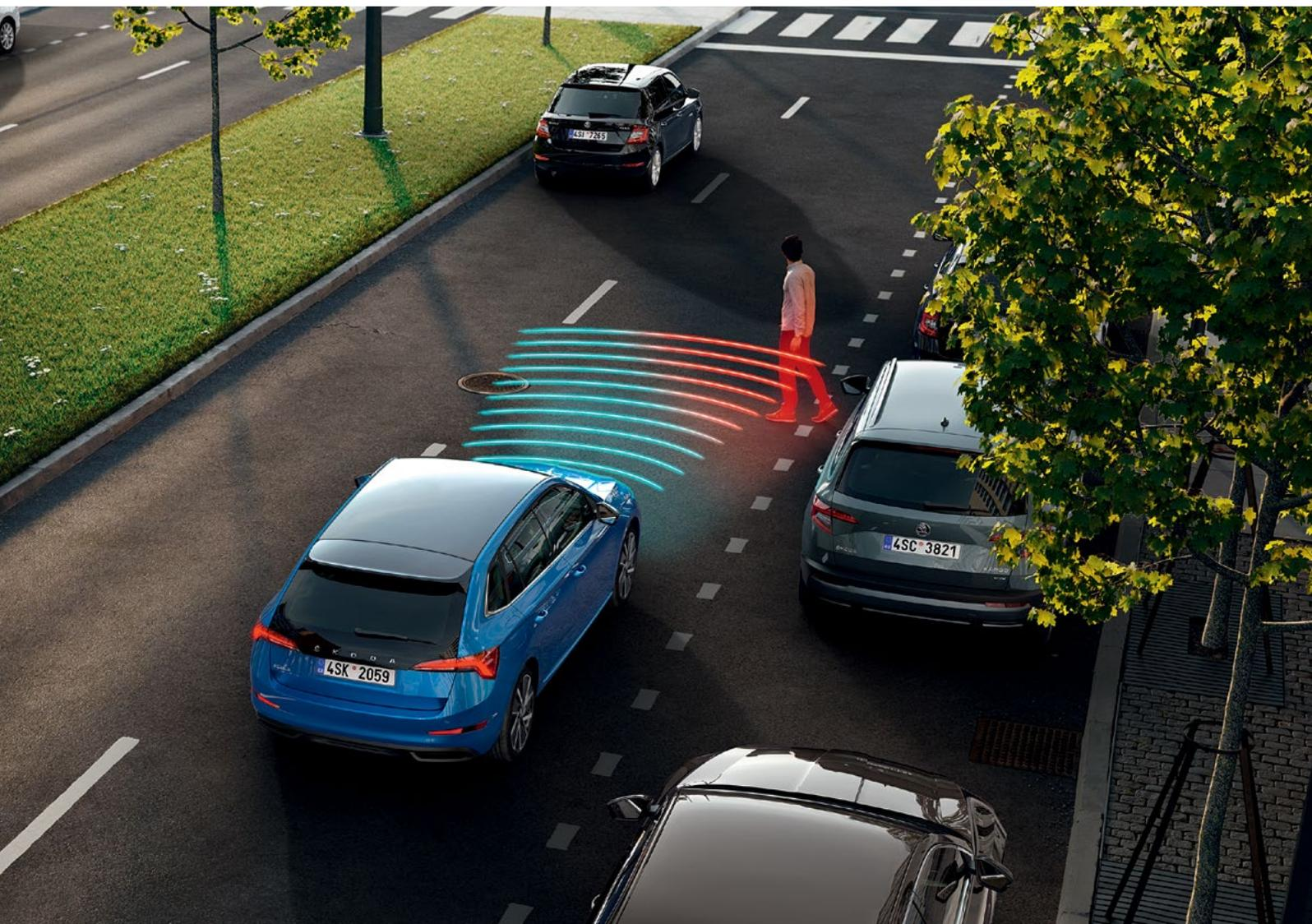
**Система поддержания дистанции Front Assist с системой предупреждающей защиты пешеходов Predictive Pedestrian Protection**
